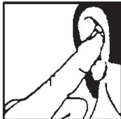
Retenir le bouchon en place jusqu'à ce que la mousse se dilate pour sceller le canal auditif.
